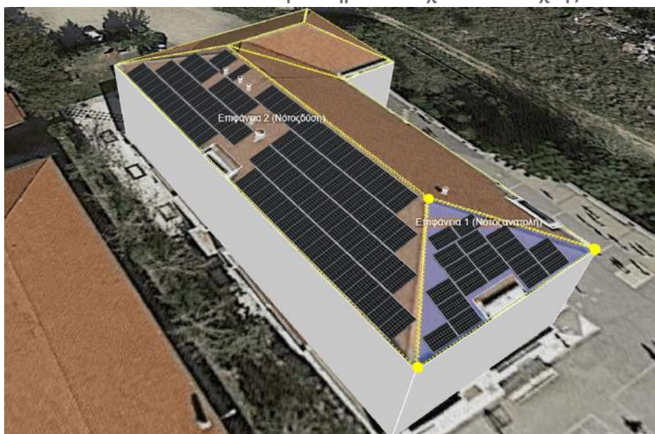
Εικόνα 6.61 Προσομοιωτικό μοντέλο φωτοβολταϊκού σταθμού 6 ου Δημοτικού Σχολείου Πολίχνης
