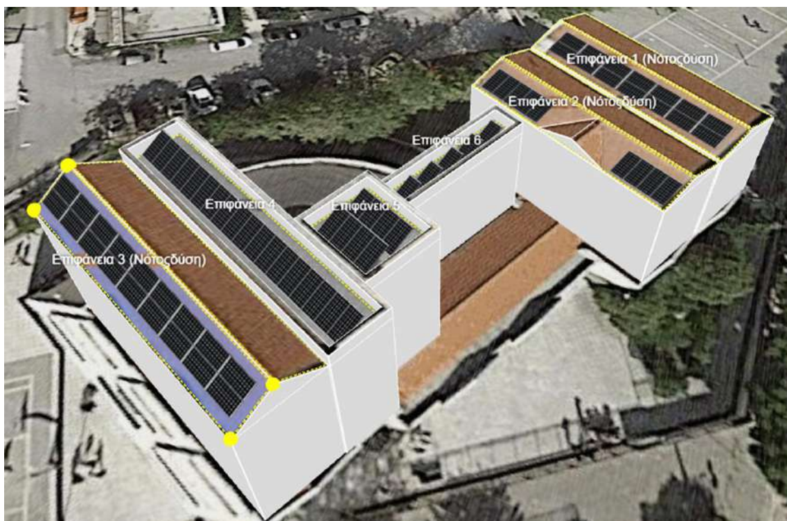
Εικόνα 6.20 Προσομοιωτικό μοντέλο φωτοβολταϊκού σταθμού 4 ου Γυμνασίου Σταυρούπολης
