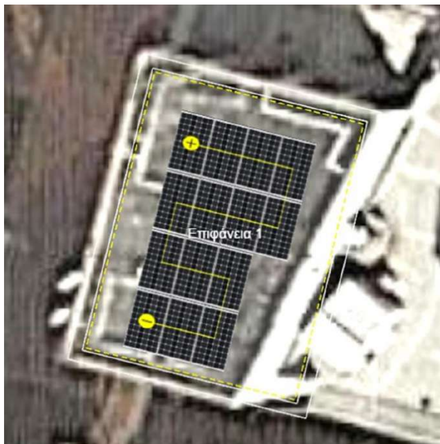
Εικόνα 6.28 Προσομοιωτικό μοντέλο φωτοβολταϊκού σταθμού Δημοτικού Ωδείου Σταυρούπολης
