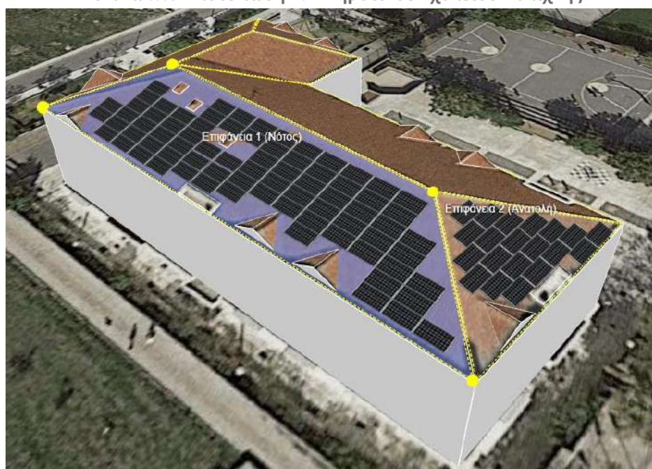
Εικόνα 6.64 Προσομοιωτικό μοντέλο φωτοβολταϊκού σταθμού 10 ου Δημοτικού Σχολείου Πολίχνης
