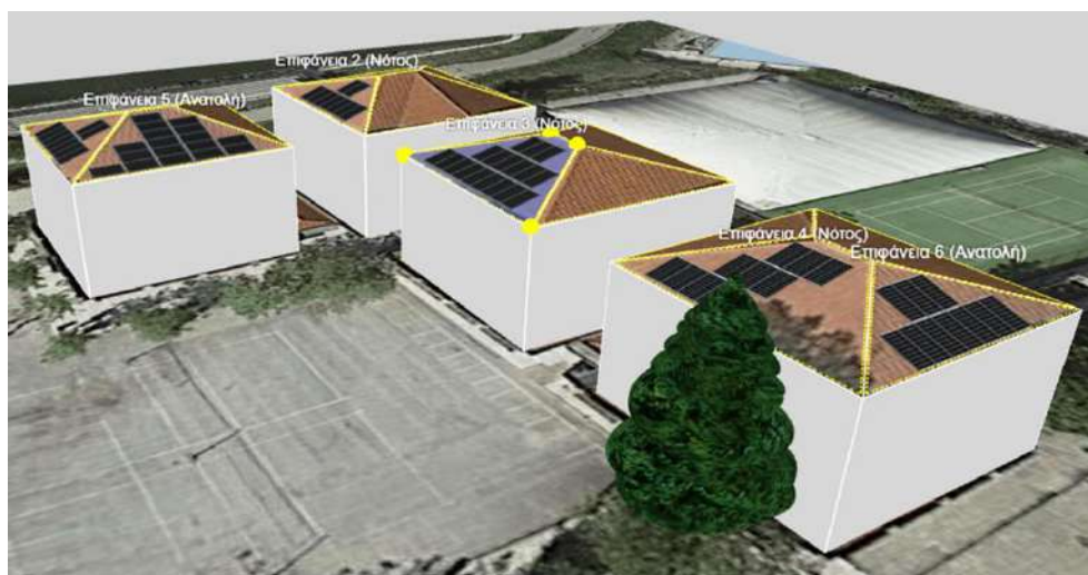
Εικόνα 6.17 Προσομοιωτικό μοντέλο φωτοβολταϊκού σταθμού 5 ου Γυμνασίου Σταυρούπολης
