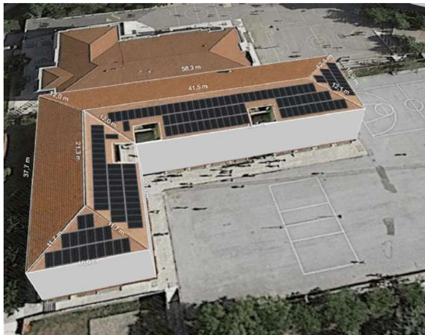
Εικόνα 6.14 Προσομοιωτικό μοντέλο φωτοβολταϊκού σταθμού 4 ου Γυμνασίου Πολίχνης
