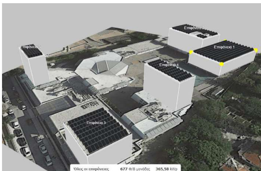
Εικόνα 6.5 Προσομοιωτικό μοντέλο φωτοβολταϊκού σταθμού 1 ου ΕΠΑΛ Σταυρούπολης
